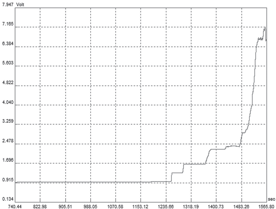
Rys. 1. Izotachoforegram dla ekstraktów z kielków gryki. Na wykresie widoczne strefy odpowiadające zidentyfikowanym kwasom: 1. kwas szczawiowy, 2. kwas winowy, 3. kwas cytrynowy, 4. kwas jabłkowy, 5. kwas mlekowy
